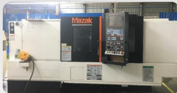
车削中心turning center
